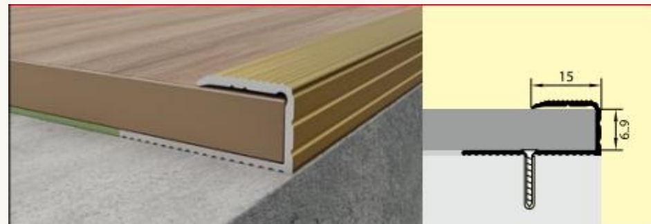
Пример завершения торца покрытия
