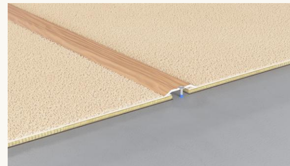
Порог с открытым креплением
